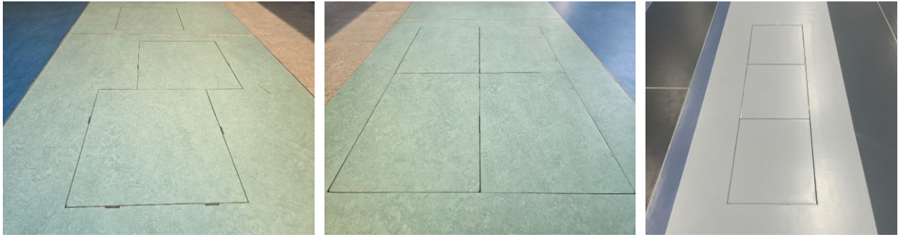
Abbildung 1 Beispiele für die Anordnung von Kraftmessplatten abhängig von zu messender Bewegungsform, sowie der Größe und Schrittlänge der Patienten*innen. LINKS: Drei Kraftmessplatten versetzt, die ersten beiden für Kinder gedacht (kürzere Schrittlänge), Platten 2 und 3 für Erwachsene. MITTE: Parallele Anordnung, speziell für Sprünge oder Sit to Stand Analysen. RECHTS: Anordnung in einer Reihe, für Erwachsene, auch Sit to Stand Analysen sind möglich.
